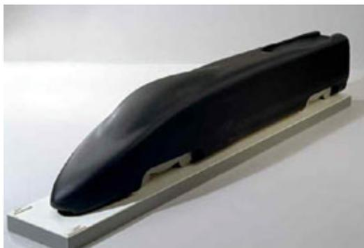
**18** Forme de motrice de TGV MX-100 utilisée pour les essais en soufflerie, 1997. Modèle au 1/15. Inv. 43540
